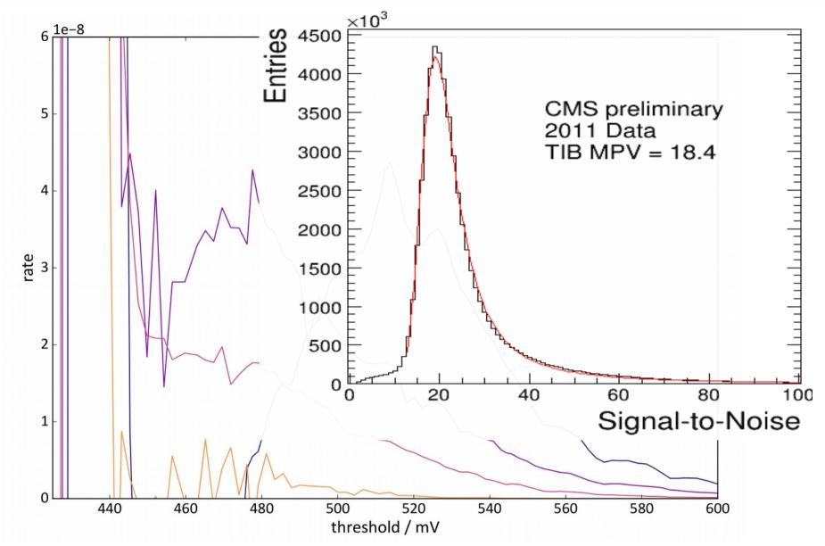
• signal height / MPV: 100mV \* 6 ke<sup>-</sup> / 35 mV ≈ 17 ke<sup>-</sup> (MIP 300µm Si ~ 22ke<sup>-</sup>)
