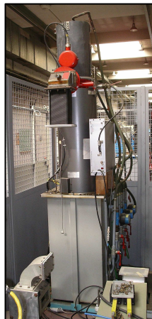
Thales Klystron 1.5 MW - 1 ms - 6.25 Hz
