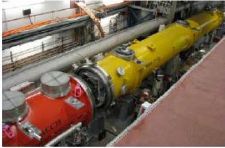
> 3 rd harmonic sc module 3.9 GHz
