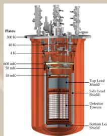
Fig. 4: CUORE Cryostat
