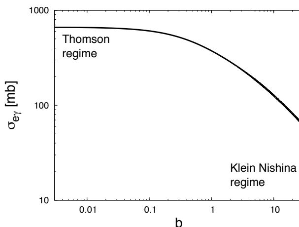
$$E_\gamma \approx \gamma_e^2 \left( \frac{B}{B_{\text{crit}}} \right) m_e = b E_e$$
