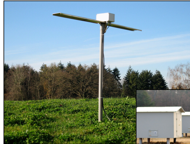
CODALEMA dipole antenna
