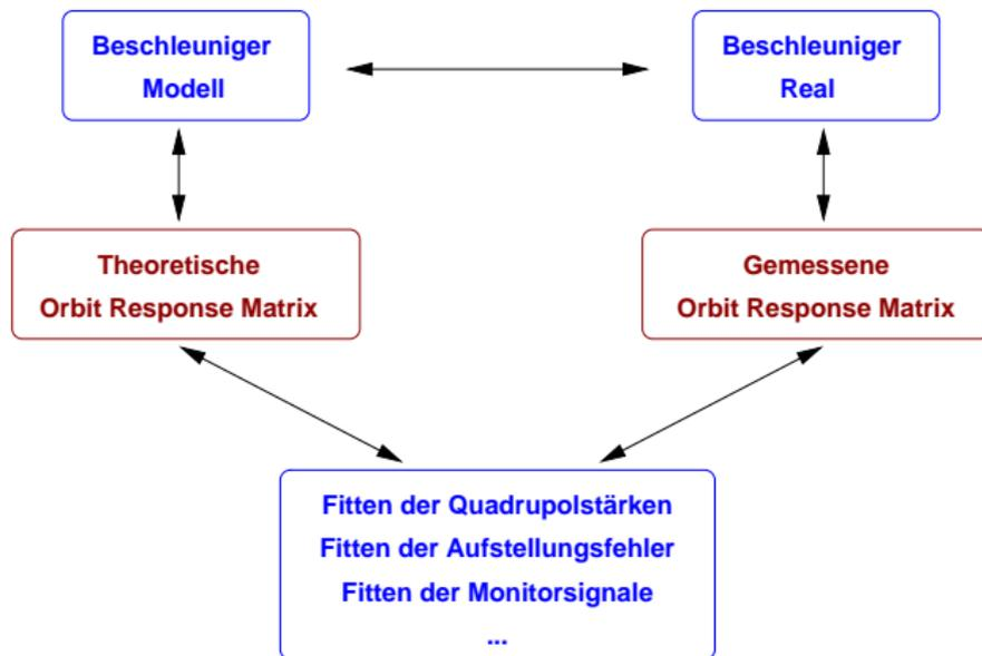
FIGURE: Kalibration des Beschleuniger Modells mittels ORM.
