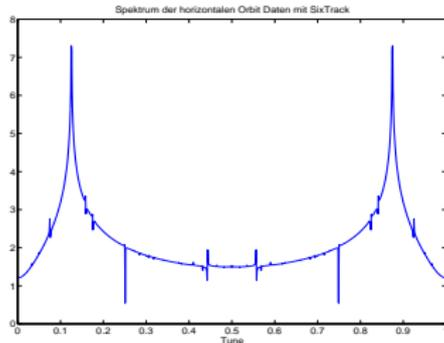
FIGURE: Spektrum horizontaler Orbitdaten erzeugt mit SixTrack. Die Simulation enthält Multipolfehler und Optikfehler,  $Q_x = 0.125$ .
