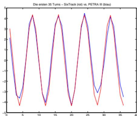
**FIGURE:** Vergleich der ersten 35 Umläufe simulierter und gemessener Orbitdaten in der horizontalen Ebene.
