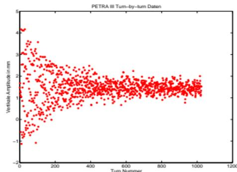
FIGURE: Zerfall der Schwerpunktsbewegung durch Dekohärenz der Teilchenbewegung innerhalb eines Bunches.
