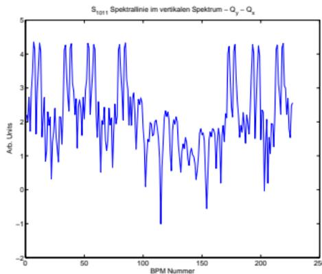
**FIGURE:** Verlauf des Sextupol Driving Terms  $S_{1011}$  entlang des Ringes ermittelt aus den Tracking Daten mittels SixTrack. Entspricht der Linie  $Q_y - Q_x$  im vertikalen Spektrum.
