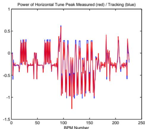
**FIGURE:** Gemessenes (rot) Powerspektrum des horizontalen Tunes im Vergleich mit Tracking Daten (blau). Das Signal ist proportional zur horizontalen Betafunktion - Optikmessung.
