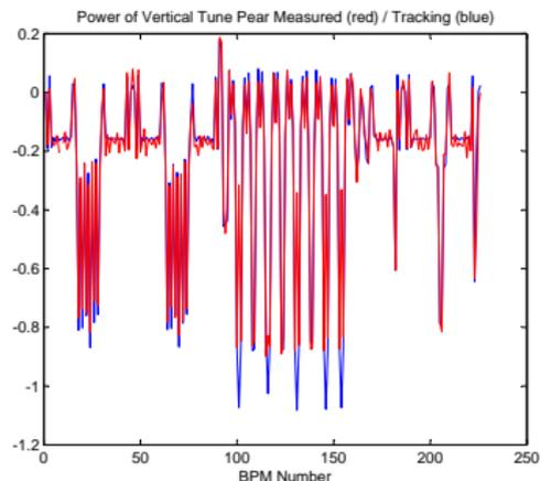
**FIGURE:** Gemessenes (rot) Powerspektrum des vertikalen Tunes im Vergleich mit Tracking Daten (blau). Das Signal ist proportional zur vertikalen Betafunktion - Optikmessung.
