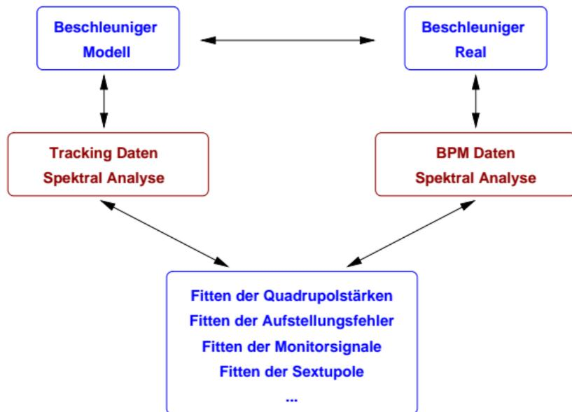
FIGURE: Kalibration des Beschleuniger Modells mittels Turn-by-turn Daten.
