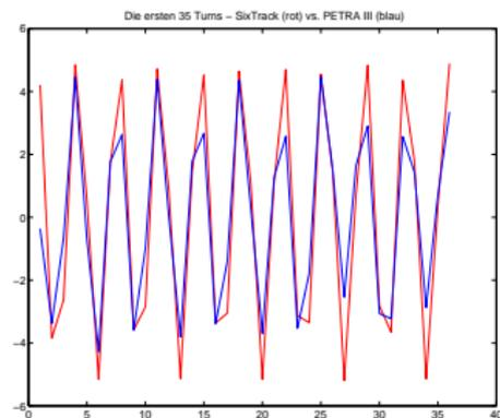
**FIGURE:** Vergleich der ersten 35 Umläufe simulierter und gemessener Orbitdaten in der vertikalen Ebene.
