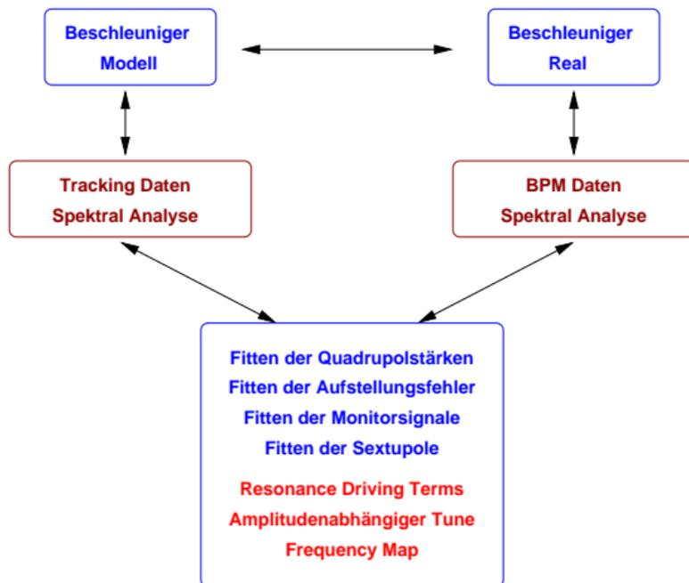
FIGURE: Kalibration des Beschleuniger Modells mittels Turn-by-turn Daten. Information über nichtlineare Dynamik
