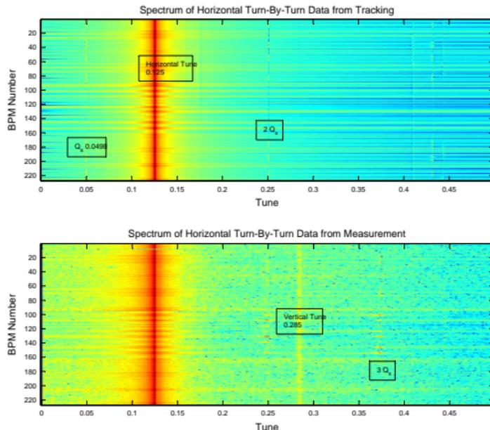
**FIGURE:** Vergleich des gemessenen horizontalen Spektrums mit Tracking Daten erzeugt mit einer modifizierten SixTrack Version (Dank an M. Vogt!). Das Modell enthält sowohl Quadrupol- als auch Multipolfehler.
