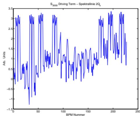
**FIGURE:** Verlauf des Sextupol Driving Terms  $S_{3000}$  entlang des Ringes ermittelt aus den Tracking Daten mittels SixTrack. Entspricht der Linie  $2Q_x$  im horizontalen Spektrum.
