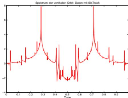
FIGURE: Spektrum vertikaler Orbitdaten erzeugt mit SixTrack. Die Simulation enthält Multipolfehler und Optikfehler.
