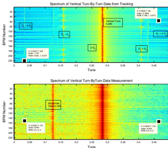
**FIGURE:** Vergleich des gemessenen vertikalen Spektrums mit Tracking Daten erzeugt mit einer modifizierten SixTrack Version (Dank an M. Vogt!). Das Modell enthält sowohl Quadrupol- als auch Multipolfehler.
