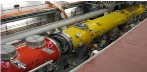
3 rd harmonic sc module 3.9 GHz
