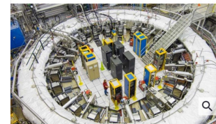
Der Speicherring des Muon-g-2-Experiments am Fermilab bei Chicago. (Foto: FNAL)
