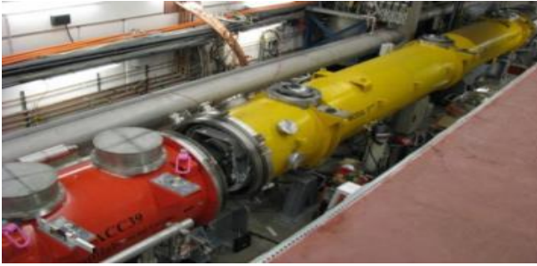
3 rd harmonic sc module 3.9 GHz
