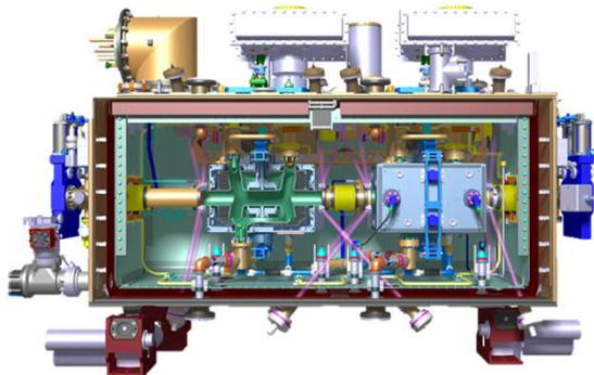
Fig – DQW Cavity and cryomodule (vertical crabbing)
