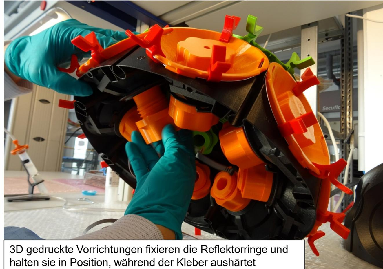
3D gedruckte Vorrichtungen fixieren die Reflektorringe und halten sie in Position, während der Kleber aushärtet
