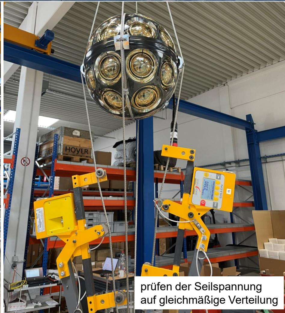
prüfen der Seilspannung
