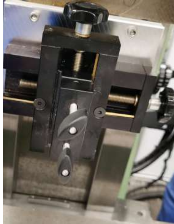
Schweißkopf-Halter mit Adapterplatte an Fräsmaschine
