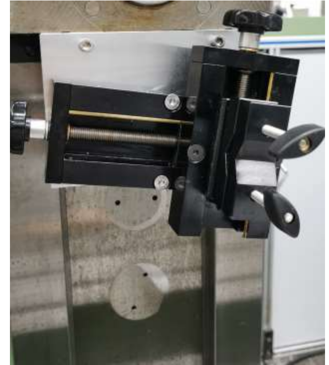
Schweißkopf-Halter mit optimierter Adapterplatte an Fräsmaschine
