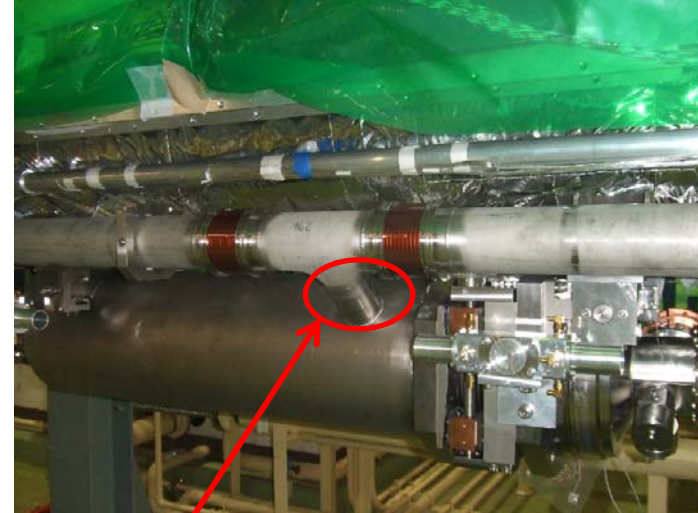
Cavity jacket : Ti helium supply pipe : SUS
