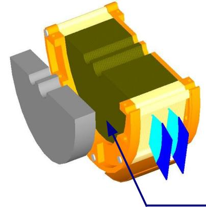
Sensor-tungsten sandwich EM calorimeters
